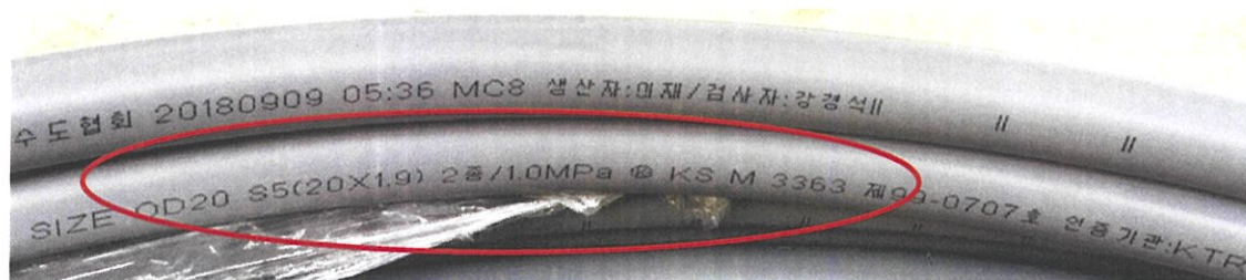
Đường kính ngoài 20 mm, dày 1,9 mm/ outside diameter 20 mm, thickness 1.9 mm
